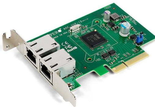
Figura 1.31- tarjeta de red Ethernet (fuente: [Wikipedia](#))
