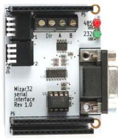
Figura 1.26- convertidor RS-485/RS-232 (fuente: [Wikimedia](#))
