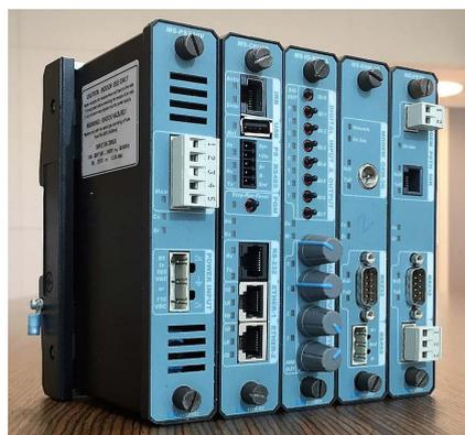
Figura 1.7- unidad terminal remota (RTU) (fuente: Wikipedia)
